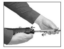
Um den Meißel zu entfernen wird die Hülse nach hinten und der Meisel aus der Aufnahme gezogen.
