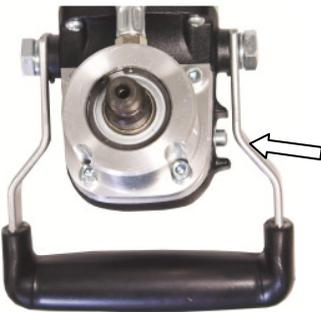
Betätigen Sie die Spindelarretierung und halten Sie diese gedrückt.
