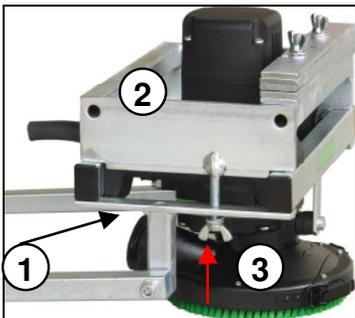
Danach setzen Sie das Gestell mit der Halterung (1) unterhalb des Rahmengriffes an und fixieren dieses mit Scheibe, Federring und Flügelmutter (3) am Rahmenaufsatz (2).
