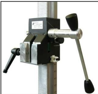
Der Maschinenhalter hat eine spezielle Schnellspannaufnahme für die Maschine ETN 152/3 P, dabei wird das Prisma am Getriebegehäuse der Maschine in die Schwalbenschwanzaufnahme des Maschinenhalters von oben eingesetzt und mit dem seitlichen Klemmhebel fest verspannt.
