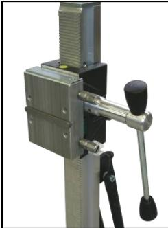
**Fahren Sie den Maschinenhalter so weit nach oben, bis dieser in der Endlage einrastet.**
