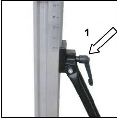
Nach dem Bohren ist die Säule wieder in die 90° Position zu bringen.
