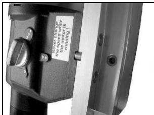
L'outil est fourni avec un support de montage, une clé de 10mm et 4 vis Allen M8x20. Le support de montage est placé sur la carotteuse avec la clé et fixé au moyen des 4 vis.
