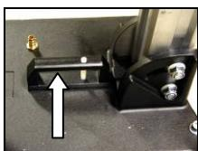
Entnehmen Sie den Vakuumgriff und die Dichtung aus der Fußplatte.
