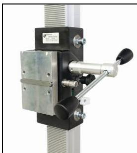
Déplacez le support de la machine vers le haut jusqu'à ce qu'il se verrouille en position haute.
