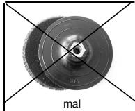
Appuyez sur le disque-meule qui est nécessaire pour votre application sur le disque de ponçage avec fermeture de type velcro. Veillez à ce que le disque de ponçage soit bien positionné sur l'outil, en fait, aussi précisément que possible. Cela permet un fonctionnement silencieux de la machine.
