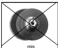
Druk het benodigde slijpwiel voor uw toepassing op de schuurschijf met Velcro-type bevestiging. Let voornamelijk op dat de schuurschijf goed op het apparaat is geplaatst, in feite zo exact mogelijk. Hierdoor zal de machine stil draaien.
