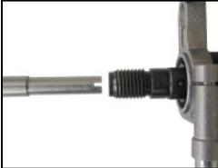
Setzen Sie die Zentrierspitze so ein, dass die Aussparungen der Zentrierspitze in den Mitnehmern der Arbeitsspindel einrasten.
