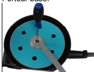
Défaire l'écrou au milieu du porteur base à l'aide de la clé fixe à ergots incluse. Si nécessaire, presser contre avec un tournevis dans la broche porte-outil.
