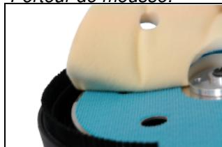
Enlever le papier abrasif, s'il existe, et retirer le porteur de mousse soigneusement.
