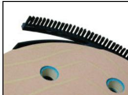
Si les balais s'usent, vous devez remplacer la couronne à balais (importante formation de poussière pendant le ponçage). A cette fin, tirer la couronne de balais usée du guidage et mettre la nouvelle dans la cannelure désignée.
