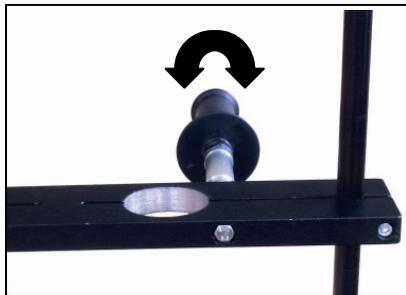
Öffnen Sie durch Drehen des Handgriffes die Spannschelle.
