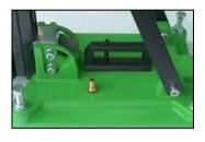
Montieren Sie den Vakuumgriff mit der mitgelieferten Schraube und Unterlegscheibe am Bohrständerfuß.
