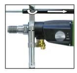
Setzen Sie die Gasdruckfeder mit dem Wassersammelring und dem zum Bohrkronendurchmesser passenden Führungsring in die Spannschelle ein. Verschieben Sie die Gasdruckfeder so weit, bis die Segmente der Krone vom Wassersammelring verdeckt sind. Ziehen Sie die Flügelschraube fest. Achten Sie beim "Überkopfbohren" darauf, dass Sie die Wasserzufuhr erst öffnen, nachdem Sie den Sauger angeschaltet und die Absaugung an der Wand bzw. Decke angesetzt haben.
